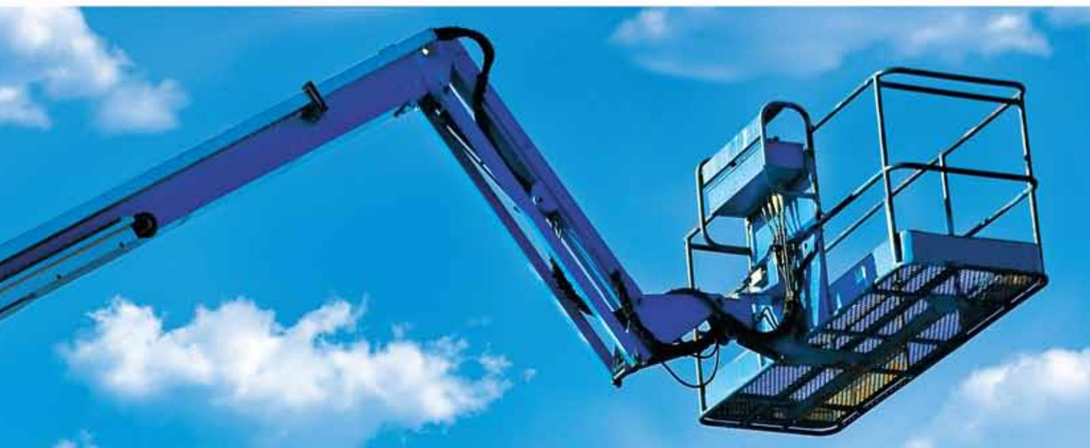
A ComLink desenvolveu o P1038 Inclínostato para cesto aéreo. Trata-se de um sensor que mede a inclinação da caçamba. Ao ultrapassar o grau ajustado, aciona um atuador que faz a compensação da caçamba. Com isso, ela se mantém sempre nivelada, evitando quedas de ferramentas ou do próprio operador.
